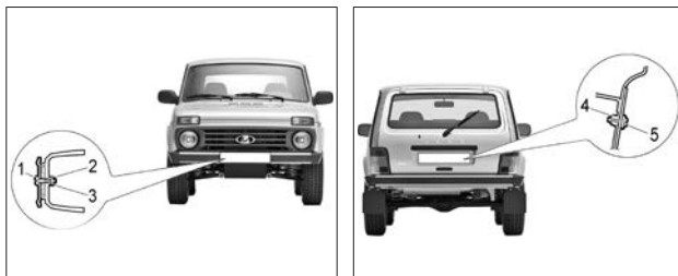
Рис. 19. Установка номерных знаков
