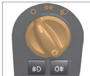
Рис. 14а. Переключатель наружного освещения
