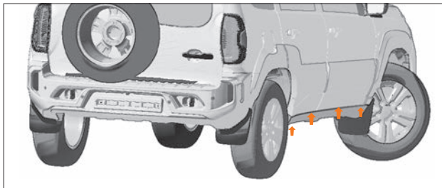
Рис. 89. Дренажные отверстия дверей и порогов
