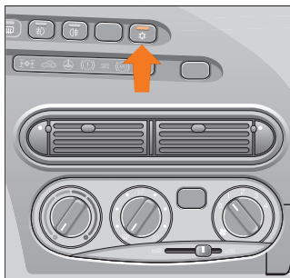
Рис. 63. Предохранение стёкол от запотевания и замерзания
