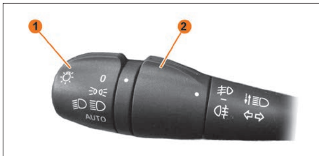
Рис. 1.26. Кольца управления на рычаге переключателя
