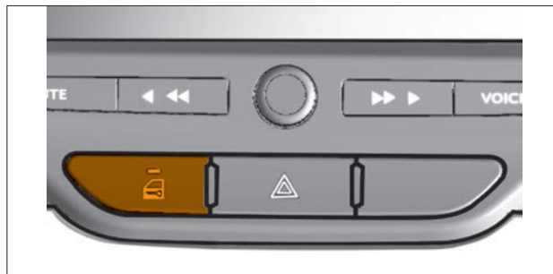
Рис. 1.10.2. Кнопка выключателя блокировки дверей (в варианном исполнении)
