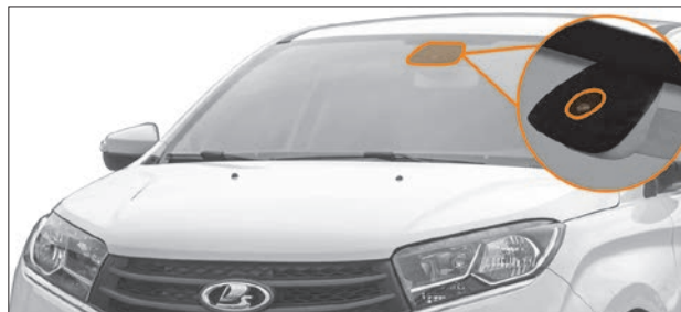
Рис. 1.28. Датчик дождя и света
