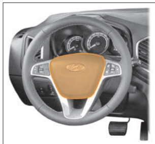
Рис. 2.12.1. Зона размещения фронтальной подушки безопасности водителя
