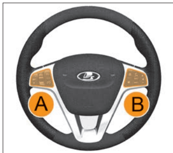
Рис. 3.11.1. Рулевое колесо с дополнительными органами управления (в варианном исполнении)
