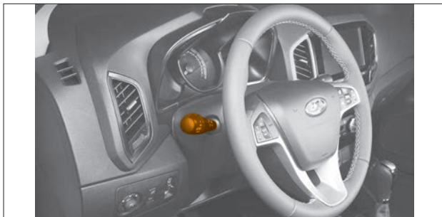
Рис. 1.24. Переключатель световой сигнализации
