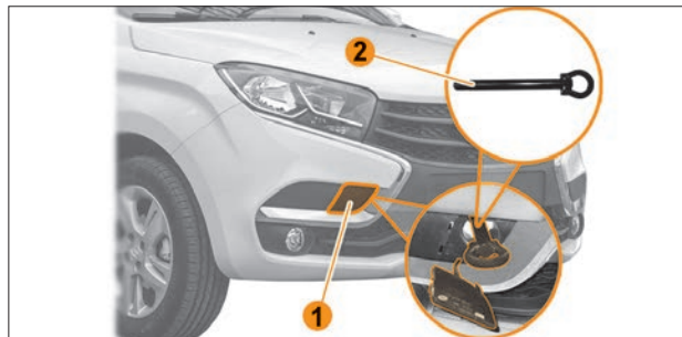
Рис. 9.6. Расположение передней буксирной проушины (в варианте исполнения)
