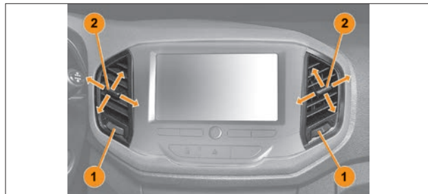
Рис. 6.2. Регулировка воздушных потоков через вентиляционные сопла (в варианном исполнении)
