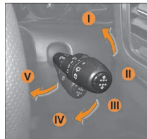
Рис. 1.30. Положения рычага управления омывом и очисткой стекол
