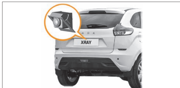
Рис. 5.7. Камера заднего вида (в варианном исполнении)
