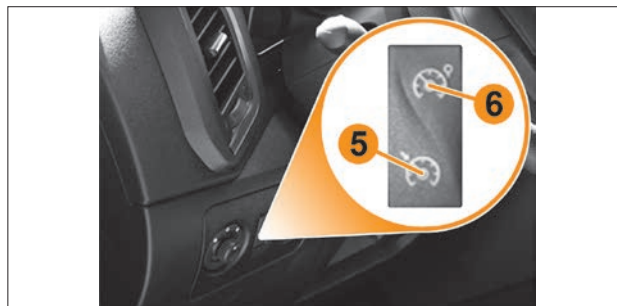
Рис. 5.2. Трехпозиционная клавиша управления системами «Круиз-контроль» и «Ограничитель скорости» на панели приборов
