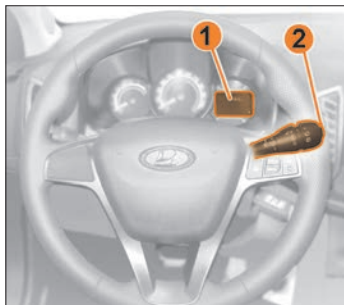
Рис. 3.6. Кнопки управления бортовым компьютером на переключателе стеклоочистителей
