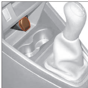
Рис. 7.5.1. Розетка для подключения дополнительного электрооборудования (в варианном исполнении)
