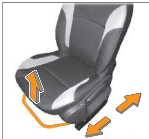
Рис. 2.1. Регулировка положения переднего сиденья
