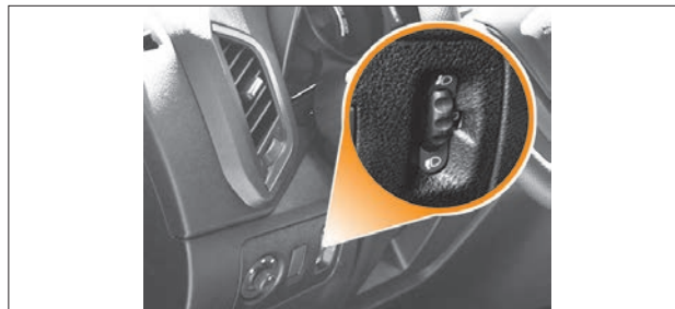
Рис. 3.15. Колесико переключателя электрокорректора угла наклона света фар
