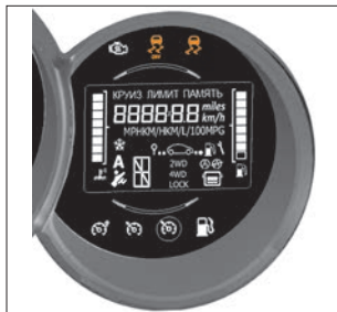
Рис. 4.6.2. Сигнализаторы «ESC» и «ESC OFF»
