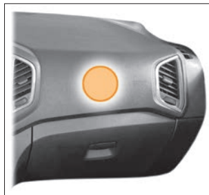
Рис. 2.12.2. Зона размещения фронтальной подушки безопасности переднего пассажира
