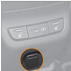
Рис. 7.5.4. Розетка для подключения дополнительного электрооборудования на центральном подлокотнике (в варианном исполнении)
