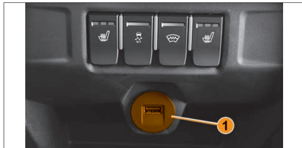
Рис. 7.12.4. USB-разъем для подключения USB-накопителя (в варианном исполнении)
