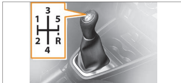
Рис. 4.2.1. Рычаг переключения механической коробки передач
