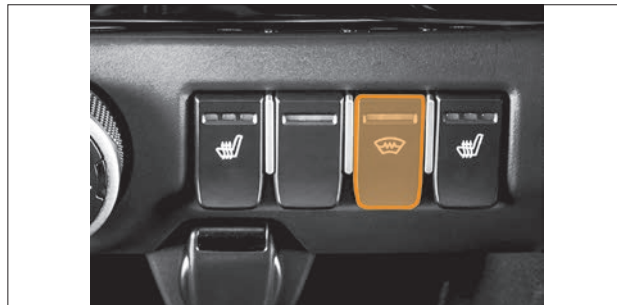
Рис. 6.5. Выключатель обогрева ветрового стекла (в варианном исполнении)
