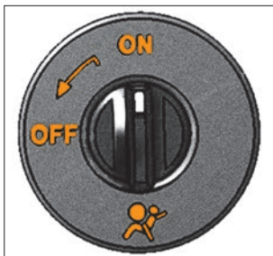
Рис. 2.17.1. Выключатель фронтальной подушки безопасности пассажира
