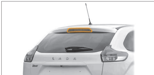
Рис. 8.23. Дополнительный сигнал торможения
