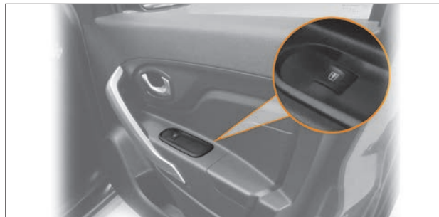
Рис. 1.21. Кнопка управления электрическим стеклоподъемником двери переднего пассажира
