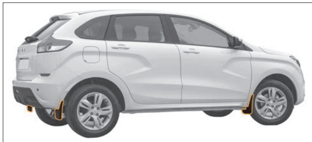
Рис. 8.30. Щитки переднего и заднего крыла
