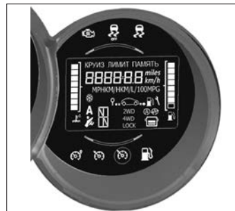
Рис. 3.8.1. Дисплей бортового компьютера
