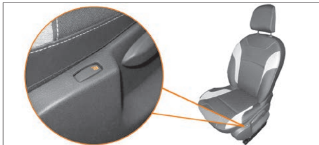
Рис. 2.4.1. Выключатель подогрева передних сидений (с фиксированными положениями)
