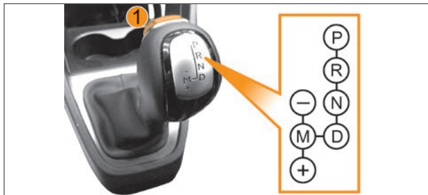
Рис. 4.2.2. Рычаг переключения автоматической коробки передач
