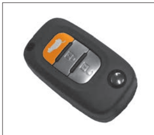
Рис. 1.5. Кнопка открывания двери задка пульта дистанционного управления
