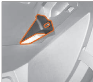
Рис. 7.3. Плафон освещения вещевого ящика
