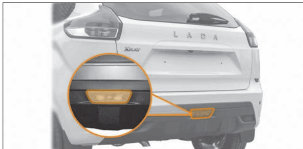
Рис. 8.14. Задний противотуманный фонарь
