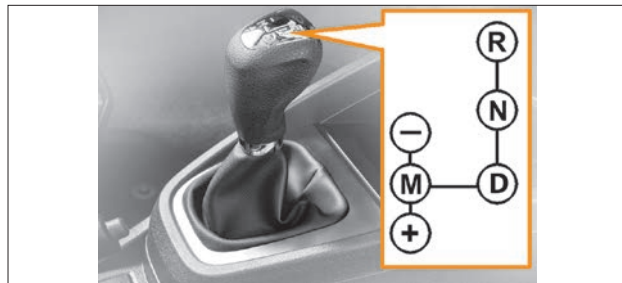
Рис. 4.3. Селектор автоматизированной трансмиссии
