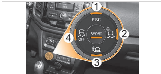
Рис. 4.7. Переключатель режимов движения системы LADA RIDE SELECT (в варианном исполнении)
