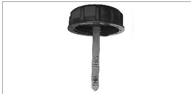
Рис. 8.7.2. Крышка бачка гидроусилителя рулевого управления со щупом
