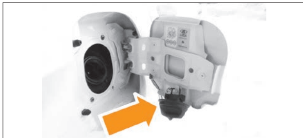
Рис. 4.9. Расположение пробки при заправке (в варианном исполнении)
