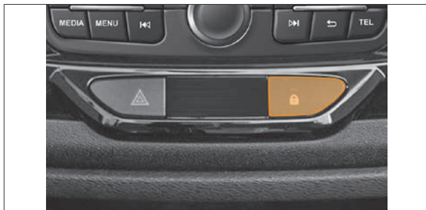
Рис. 1.10.1. Кнопка выключателя блокировки дверей (в варианном исполнении)
