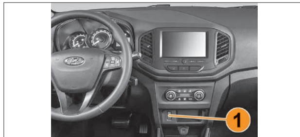
Рис. 4.6.1. Выключатель «ESC OFF» автомобиля LADA XRAY (в варианном исполнении)
