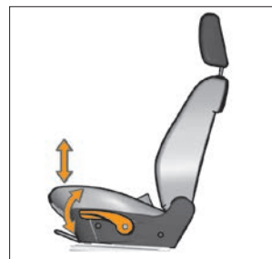
Рис. 2.3.1. Регулировка сиденья по высоте (в варианном исполнении)
