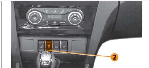
Рис. 4.6.4. Выключатель «ESC OFF» автомобиля LADA XRAY Cross (в варианном исполнении)
