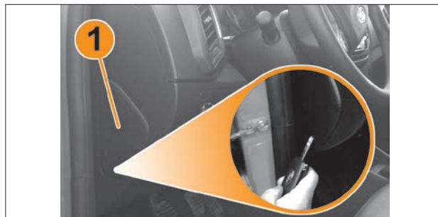
Рис. 8.29 Демонтаж крышки блока предохранителей и реле салона
