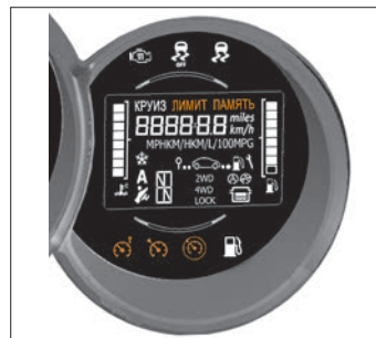
Рис. 5.4. Дисплей комбинации приборов
