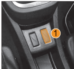
Рис. 4.6.3. Выключатель «ESC OFF» автомобиля LADA XRAY Cross (в варианном исполнении)
