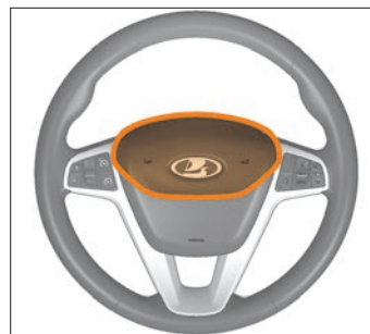
Рис. 3.10. Активация звукового сигнала
