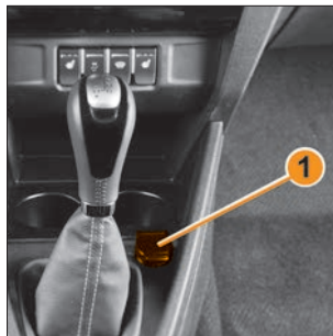
Рис. 7.5.2. Розетка для подключения дополнительного электрооборудования (в варианном исполнении)
