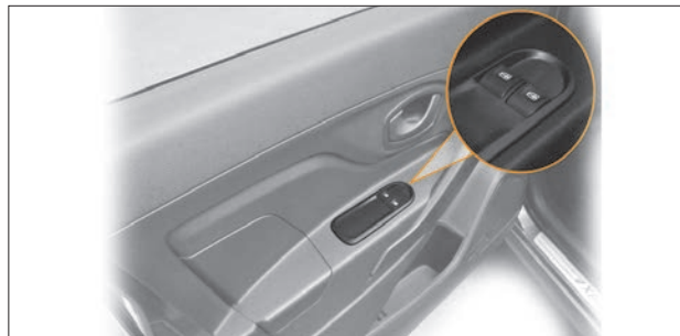
Рис. 1.18. Блок переключателей на двери водителя
