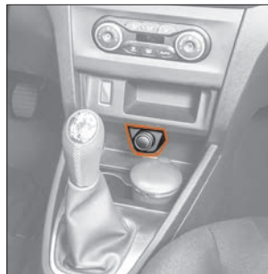
Рис. 7.6. Установка прикуривателя (в варианном исполнении)
