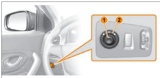
Рис. 3.13. Регулировка зеркал заднего вида с электроприводом (в варианном исполнении).
