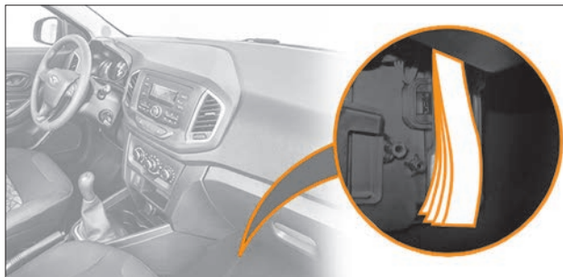
Рис. 6.6. Замена фильтра салона
