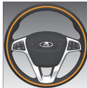
Рис. 3.11.4. Зоны обогрева рулевого колеса (в варианном исполнении)
