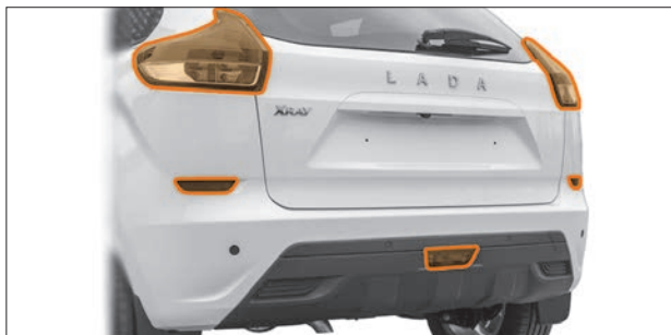
Рис. 9.11. Рассеиватели световых приборов задние
