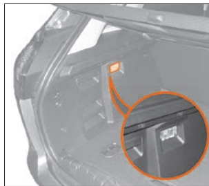
Рис. 7.4. Плафон освещения багажного отделения
