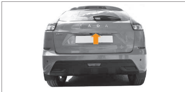
Рис. 1.9. Кнопка открывания двери задка
